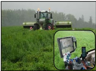
● トラクター (後付け自動操舵機能付)
