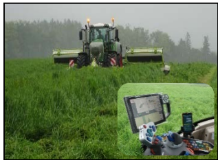
● トラクター (後付け自動操舵機能付)
