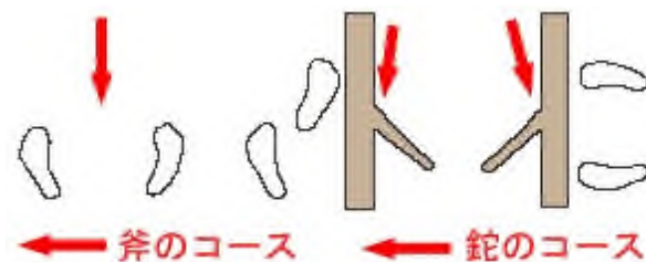
図 斧と鉋の振り方 斧は振り終わったら足の手前で地面に接するように振る 鉋は足の方向に振らないように注意する
