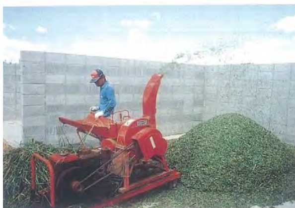
カッター式による刈草の破碎例
