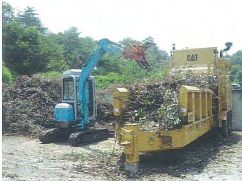
バックホウによる破碎機への投入作業（国営讃岐まんのう公園）
