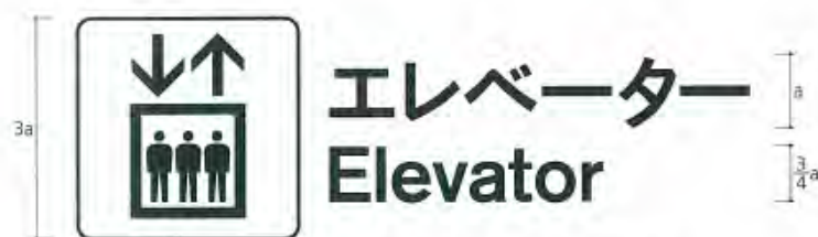
同じ視距離から図記号と文字を読めるように(基本形で)レイアウトする例
