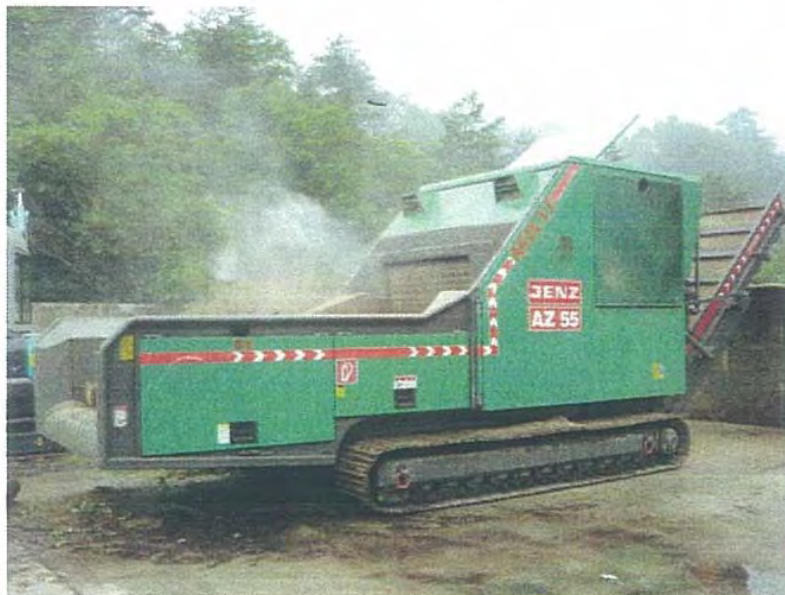
移動式大型破碎機（国営讃岐まんのう公園）
