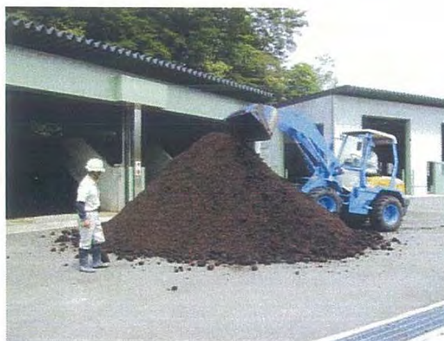
ホイローダーによる切返し作業 (国営讃岐まんのう公園)
