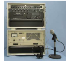
臨時災害用FM放送設備
