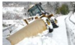
除雪車の転倒防止
