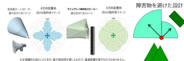
また、高い出力パワーも両立させているため、優れた到達距離を持ち、遠くまで聞き取れる音が届きます。従来型が垂直方向へ球面状に音が広がるのに対し、この型は垂直方向に強い指向性を持ち、直下での不快な音量感を抑え、耳障りになりにくいという特徴があります。
