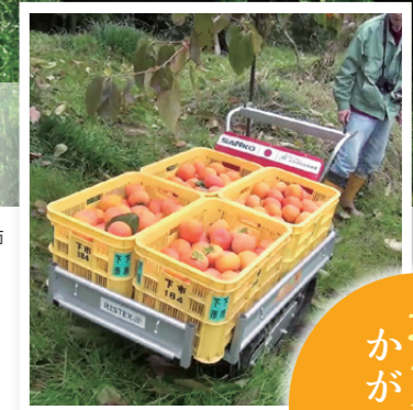
電動運搬車で収穫した柿をリモコン操作で運搬。
