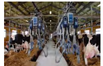
● 搾乳ユニット自動搬送装置
