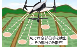
農薬散布（ピンポイント散布） AIで病変部位を検出し、その部分のみ散布
