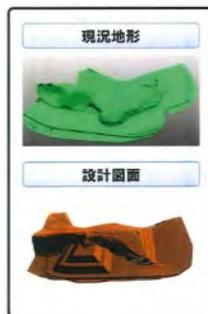
3次元測量データ(現況地形)と設計図面との差分から、施工量(切り土、盛り土)を自動算出。
