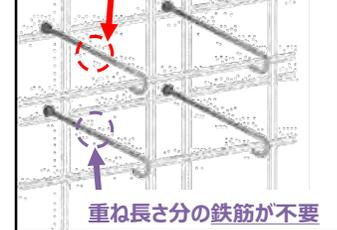
機械式鉄筋継手工法
