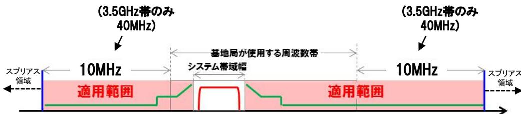
図: 基地局のスペクトラムマスクの規定の適用範囲
