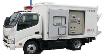
災害対策用移動電源車
