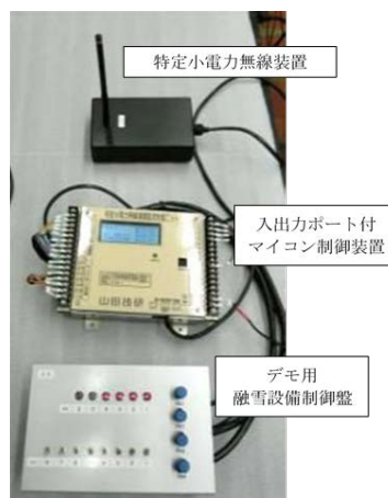
図 1 無線融雪監視制御装置
