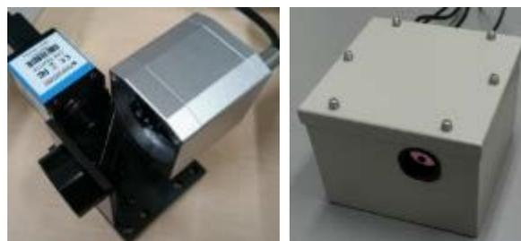
図 1: 試作した同軸光学系 (左) と防水筐体 (右)。
