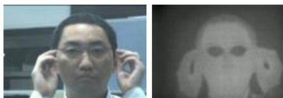
図 3：試作した同軸光学系で撮影した色画像（左）と温度画像（右）。
