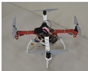
図 2 開発した制御器を実装したマルチロータヘリコプタ
