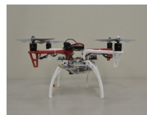
図 2 開発した制御器を実装したマルチロータヘリコプタ
