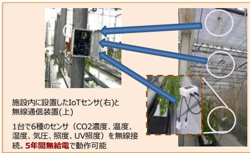
施設内に設置したIoTセンサ(右)と無線通信装置(上)
