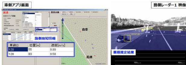
図10 車側における路側検知情報の活用例(左)、路側レーダーの検知データ例(右)
