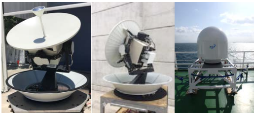
図 1 調査船搭載用プロトタイプ衛星地球局の外観
