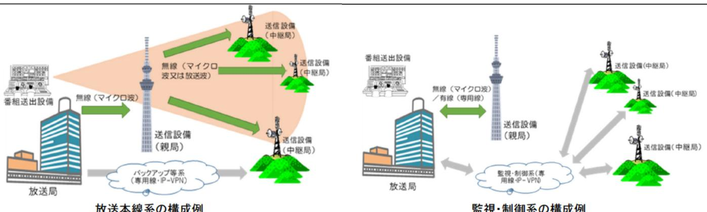
※ 放送本線系内は専用通信方式であるため、放送番組送出設備における措置を行うことで、放送本線系内の分離が可能となる。
