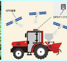
GPS車速連動 施肥中耕機 (中耕除草中に均一な施肥が可能)
