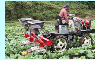
GPS車速連動 施肥中耕機 (中耕除草中に均一な施肥が可能)
