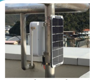
※写真は左が中継器、右がソーラーパネル
