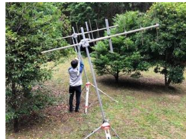
山麓部基地局側に森林内部に向けて八木アンテナを設置
