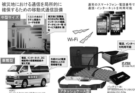
図4 移動式 ICT ユニット (MDRU) (被災地におけるスマホの通信確保)
