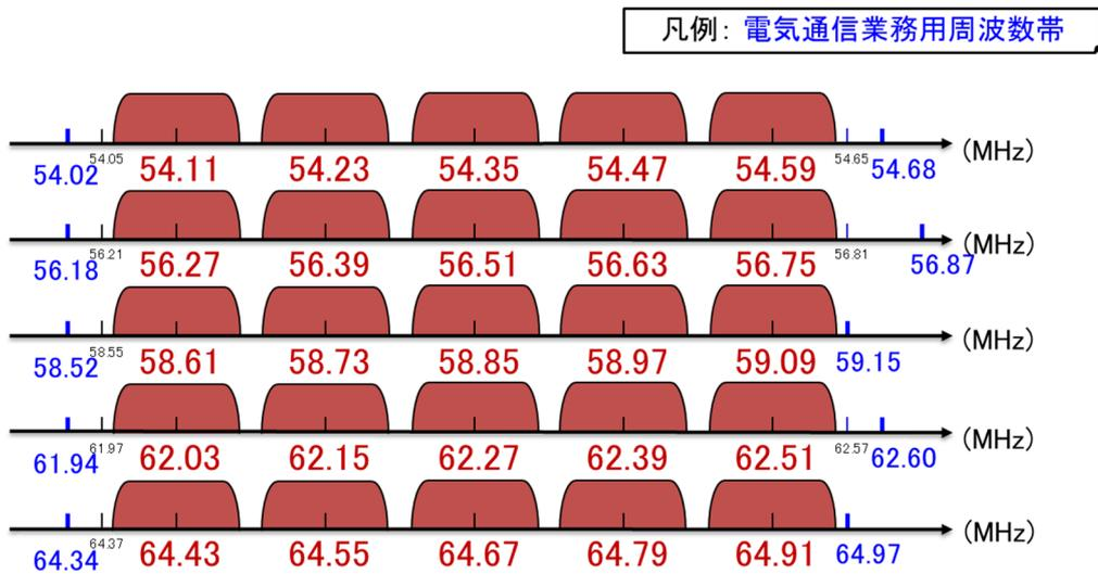
図 3-2 高度化システムのチャンネル配置
