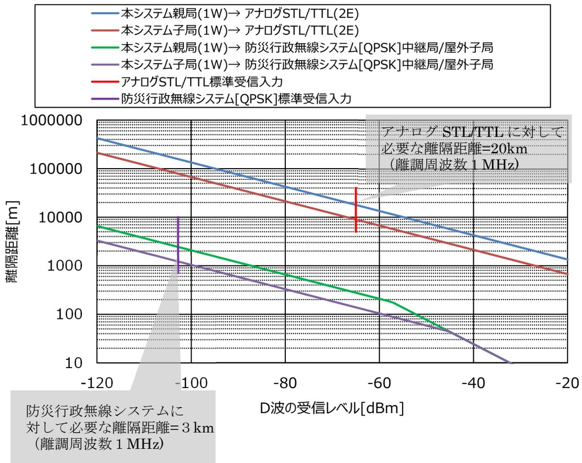
図 2-14 U 波出力1W(対 STL/TTL、防災行政無線[QPSK]) + 離調周波数1MHz
