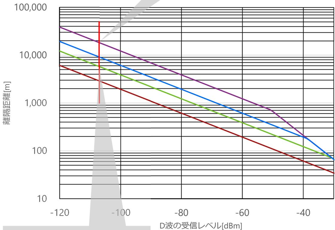
高度化システム(親局)から公共用,一般業務用(陸上移動業務の局,陸上移動局/携帯局)[緑実線]に対して必要な離隔距離=5.8km (離調周波数 1MHz)
