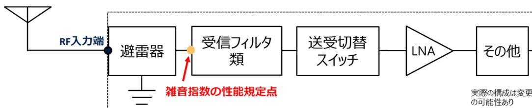
図 3-5 雑音指数の性能規定点の例
