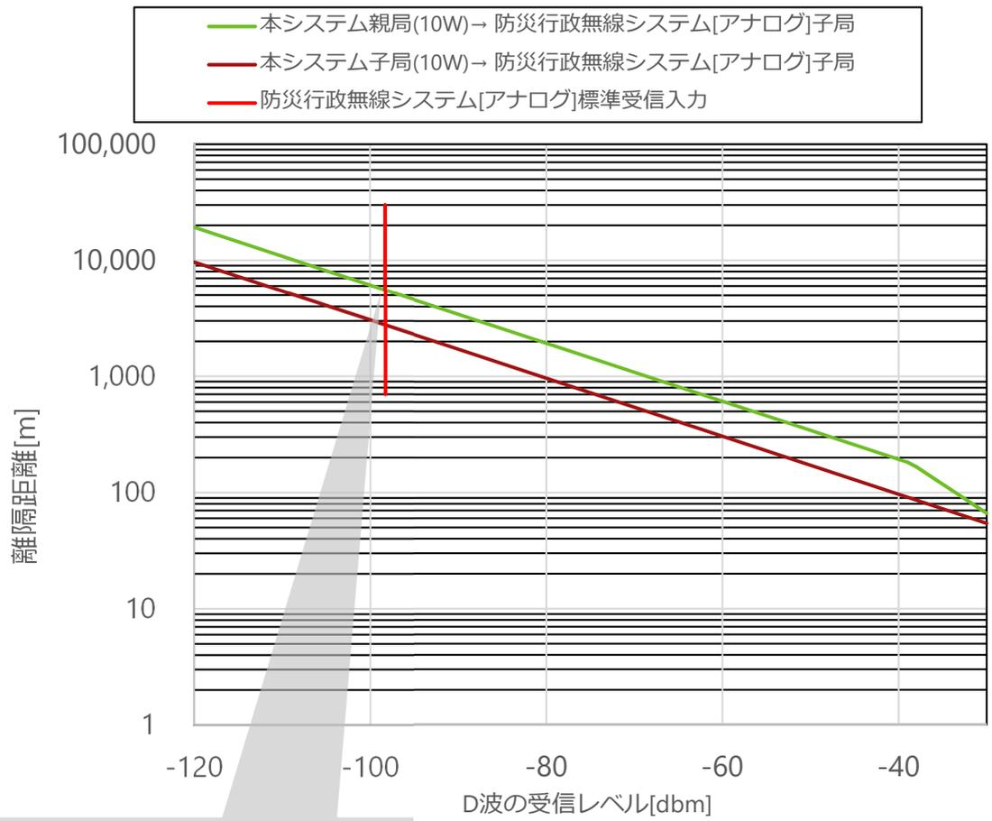
高度化システム(親局)から防災行政無線システム[アナログ][緑実線]に対して必要な離隔距離=5.4km (離調周波数 1MHz)
