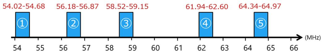
図 3-1 現行システムのチャンネル配置
