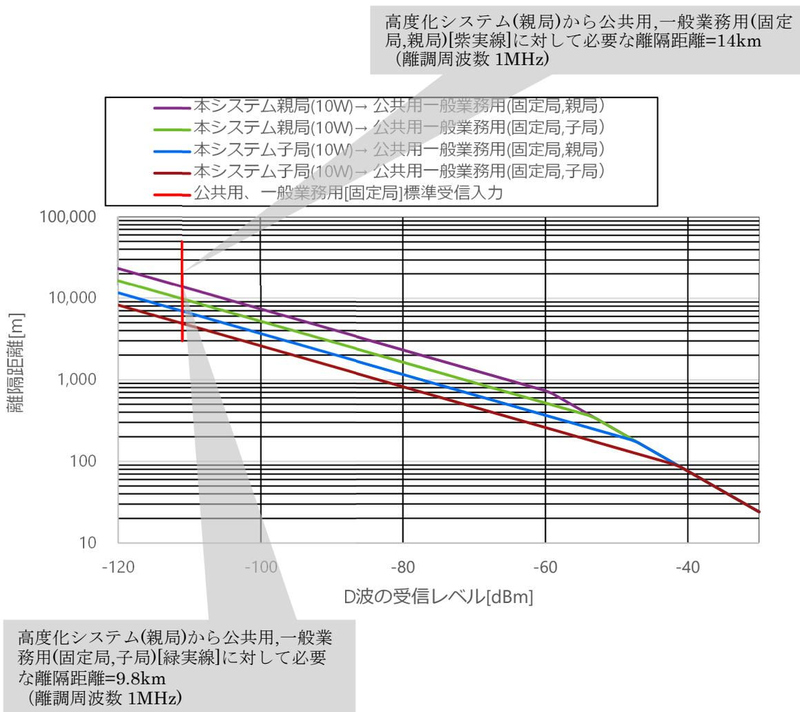
図 2-16 U波出力 10W(対 公共用及び一般業務用[固定局]) + 離調周波数 1MHz
