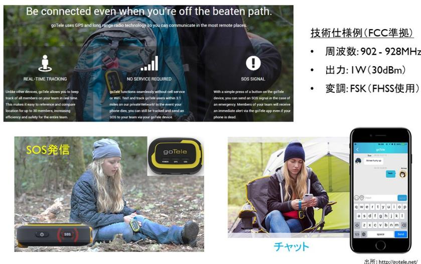
図 1 - 5 FH 方式の小電力無線局の例 (goTele)
