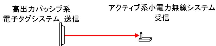
参図3-1 高出力型パッシブ系電子タグシステムからアクティブ系小電力無線システムへの干渉モデル
