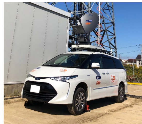
車載型移動基地局 74台
