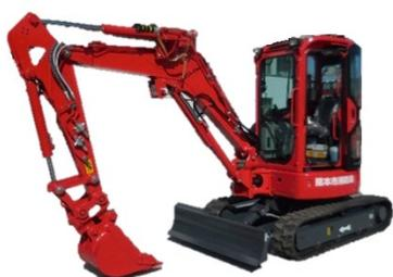
津波等によるがれき、土砂崩れ等による障害物を除去し、道路の啓開を行うとともに、救助隊等と連携して活動障害となる障害物の除去を行い、効果的な救助活動を行う車両。大規模工場火災等の残火処理時には、収容物の排出活動にも活用できる。
