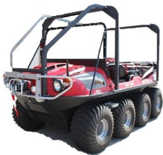
不整地において高い走破性を有し、津波や大規模風水害での活動を支援するための小型車両。水上においても移動が可能な水陸両用性能を有する。
