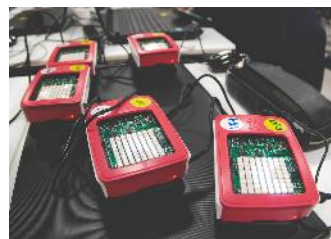
避難経路誘導システム
