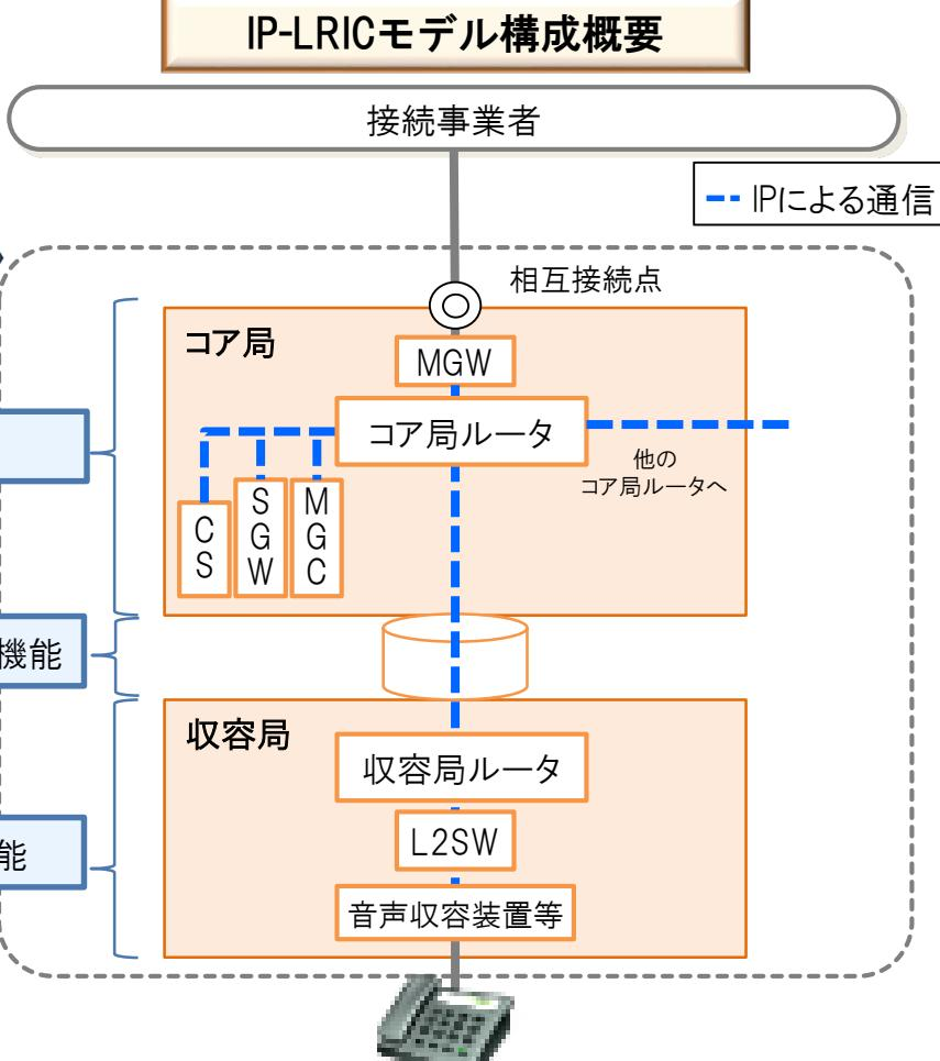
・MGW(Media GateWay):IP網とPSTNにおける回線交換方式とを変換する装置
