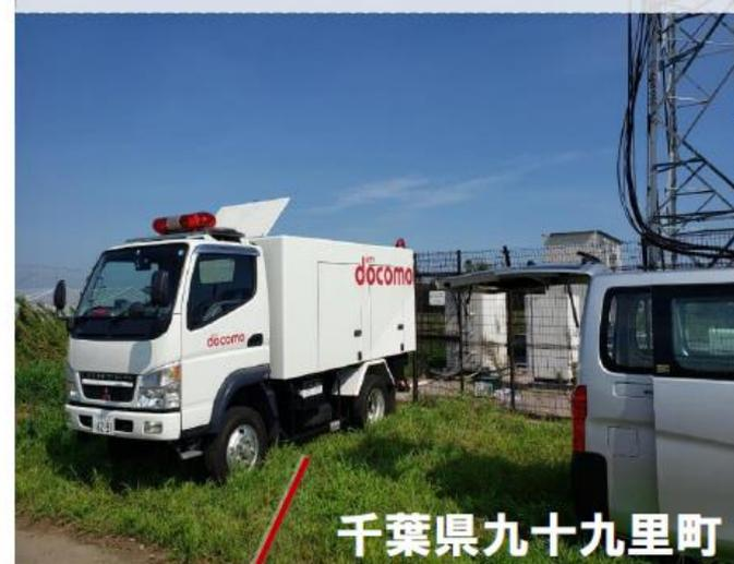
移動電源車にて電源供給を実施し、応急復旧
