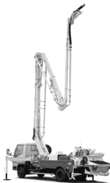
図 21 コンクリートポンプ車
