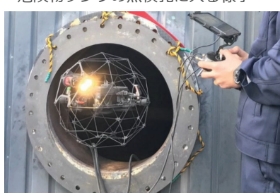
危険物タンクの点検孔に入る様子
