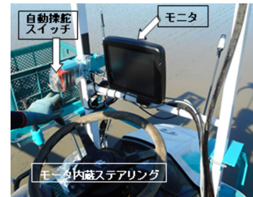
写真 RTKGNSS 自動操舵装置装着田植機
