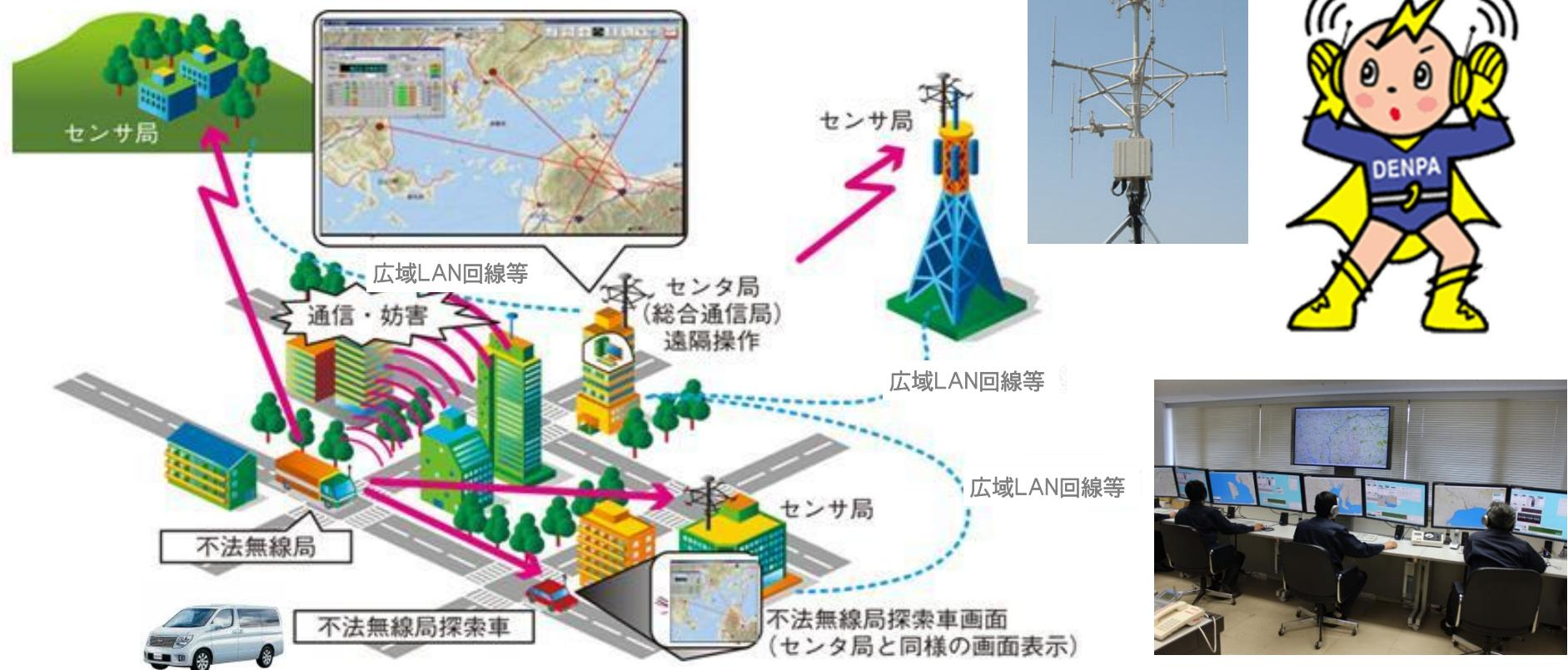
各地に設置されたセンサ局や車両に搭載されたセンサ局を、総合通信局等に設置されたセンタ局から遠隔操作することにより、センサ局で受信した電波をモニタしたり、その電波発射源の方位等を測定して、不法無線局の位置等を特定します。
