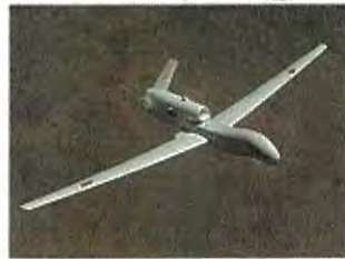
Global Hawk (米 Northrop Grumman) 翼長: 34.5m, 航続距離: 12,000km ターボファン, 価格: 1000万ドル/システム
