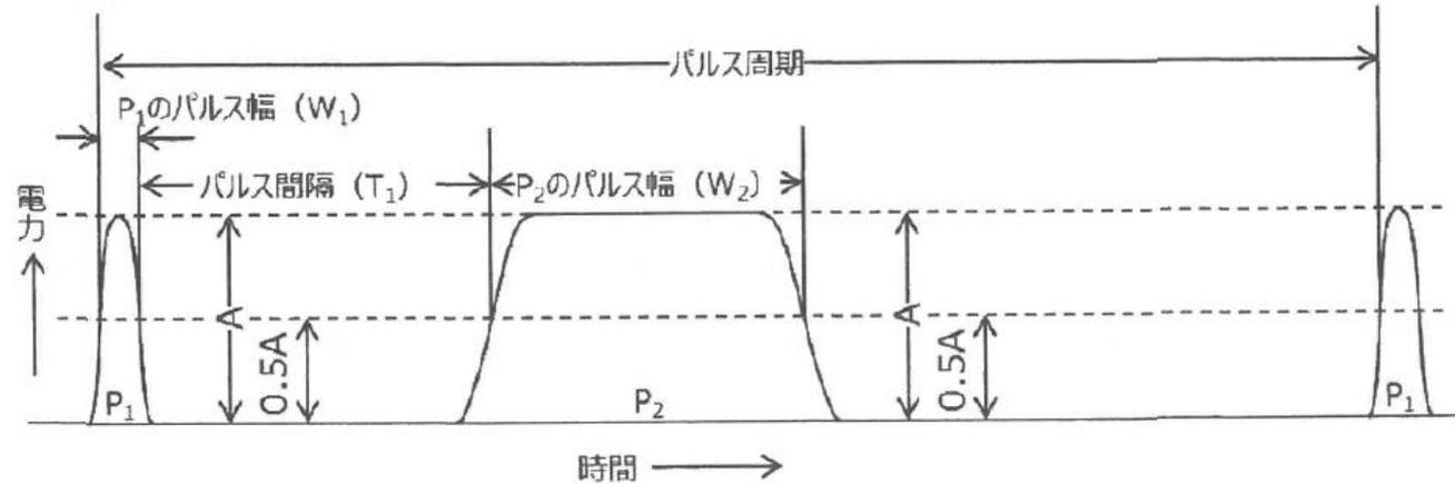
注4 一のパルス周期期間中に線形周波数変調を行うための周波数の偏移幅（以下、「チャープ幅」という。）、 $P_1$ のパルス間隔 $T_1$ 、 $P_2$ のパルス幅 $W_2$ 及び $P_1$ のパルス幅 $W_1$ と $P_2$ のパルス幅 $W_2$ の差並びに $P_1$ のパルス幅 $W_1$ の繰り返し周波数を乗じて得た値（以下「デューティー比」という。）は、次の通りであること。なお、各パルス間隔及び各パルス幅は、それぞれ電力0.5Aを規定とする各パルスの立ち上がり時間と各パルスの立下り時間とする。
