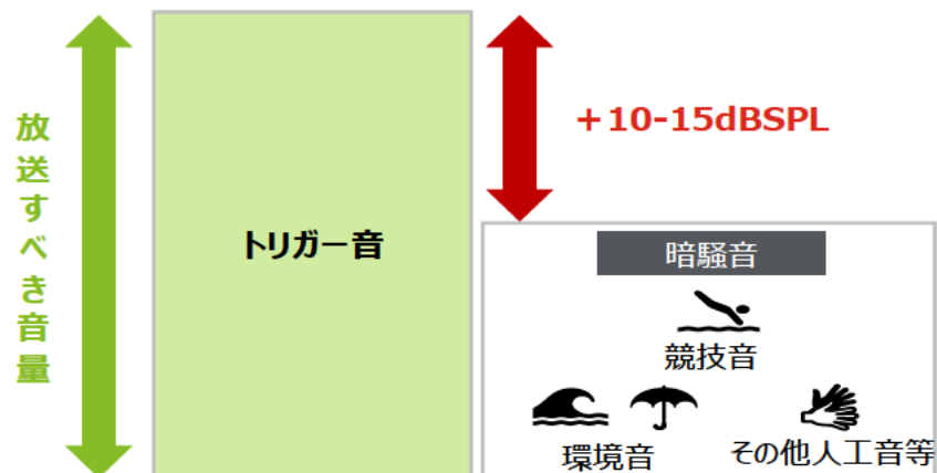
図表 3-67 暗騒音と放送すべきトリガー音量の考え方
