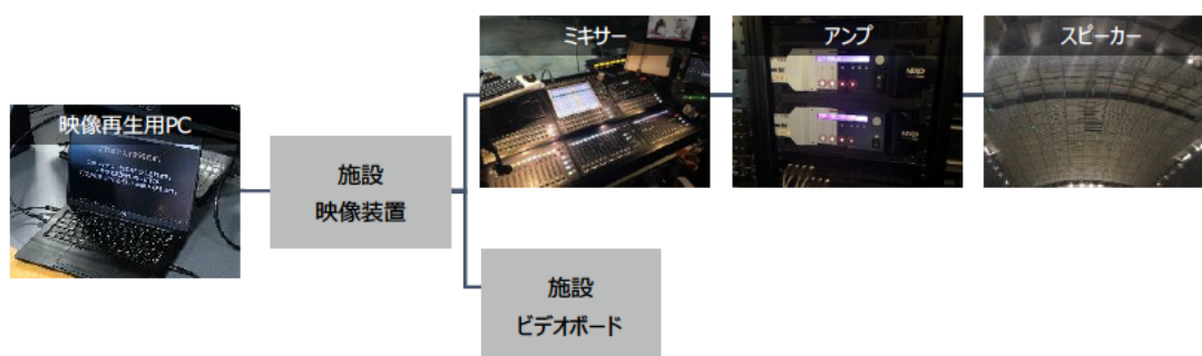
図表 3-50 競技用放送設備のシステム構成（札幌ドーム）
