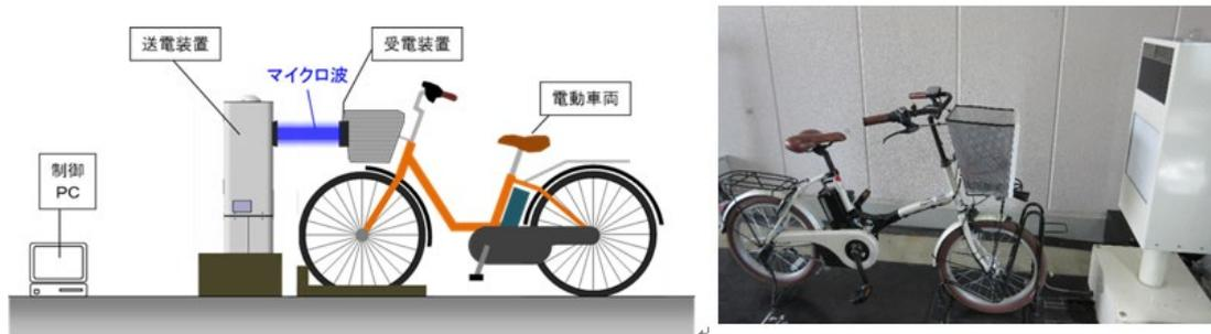
図 1.1.4 電動車両向け空間伝送型ワイヤレス電力伝送システムの社会実証実験
