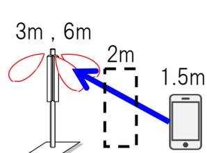
参 2. 2 勧告 ITU-R P.1411 Below roof-top (ターミナル間、near street level) モデル<sup>注1</sup>
