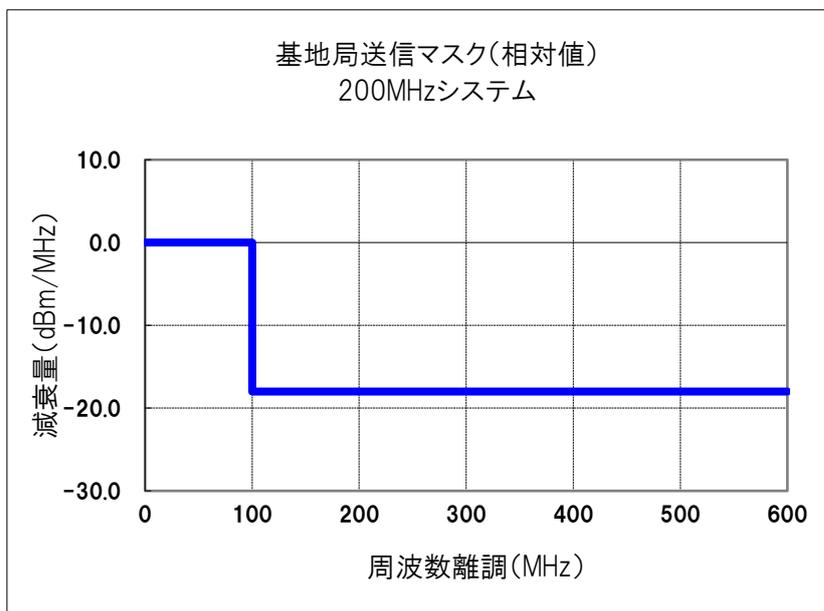
システム帯域幅の中心から離調 300MHz まで : ACLR を基に設定 (-13dBm/MHz)
