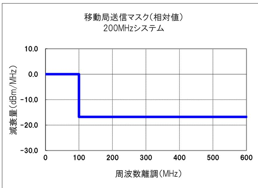
システム帯域幅の中心から離調 300MHz まで : ACLR を基に設定 (- 16.79dBm/MHz)
