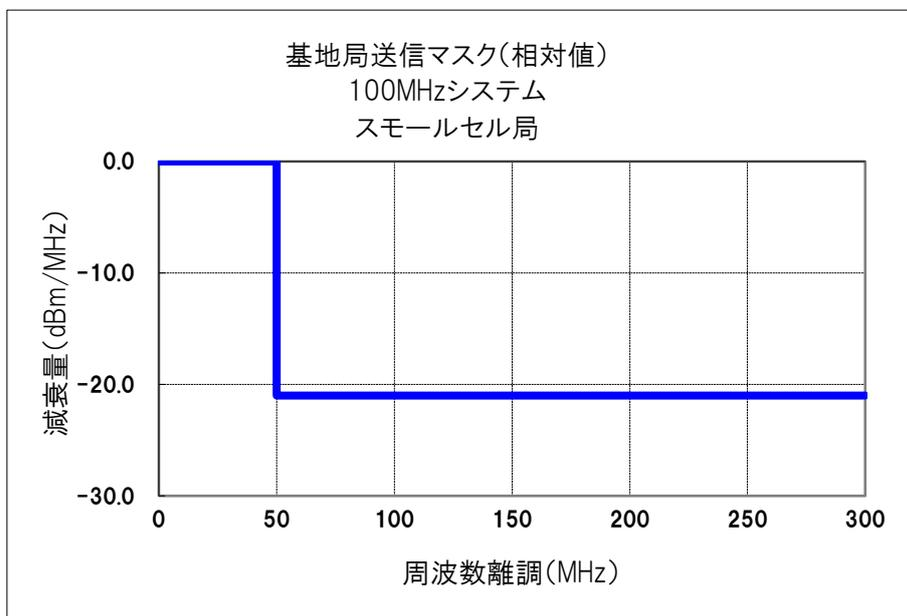
システム帯域幅の中心から離調 250MHz まで : ACLR を基に設定 ( - 16dBm/MHz)
