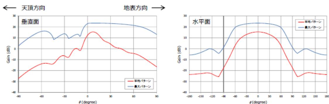
図5. 2. 2. 1-1 基地局の空中線指向特性 [チルト10度（下向き）]
