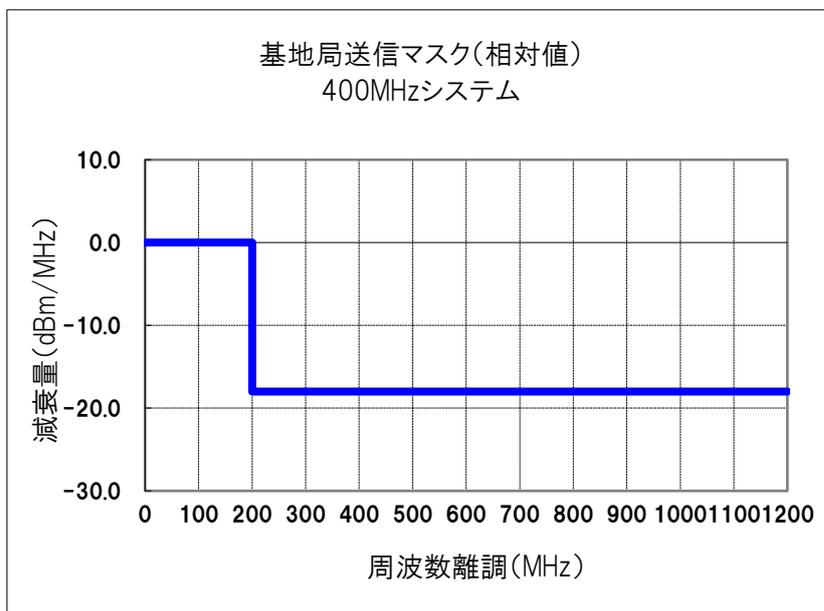
システム帯域幅の中心から離調 600MHz まで : ACLR を基に設定 (-13dBm/MHz)
