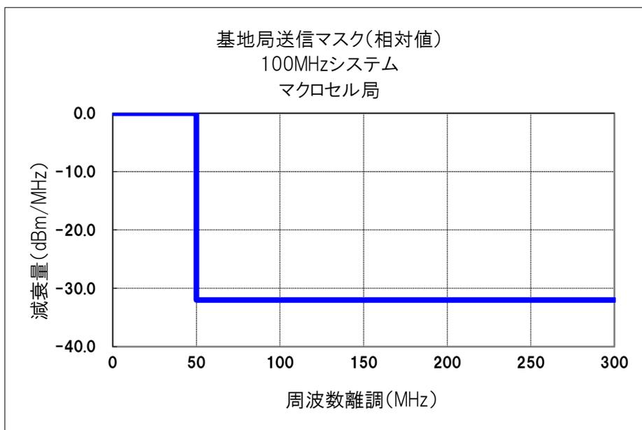
システム帯域幅の中心から離調 250MHz まで : ACLR を基に設定 ( - 4dBm/MHz)
