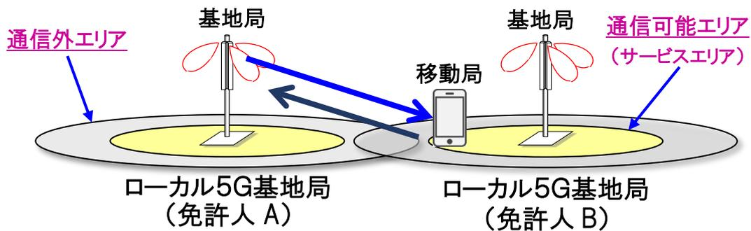
図4. 2. 1. 1-1 同一周波数を使用する5Gシステム相互間の干渉経路（同期運用時）
