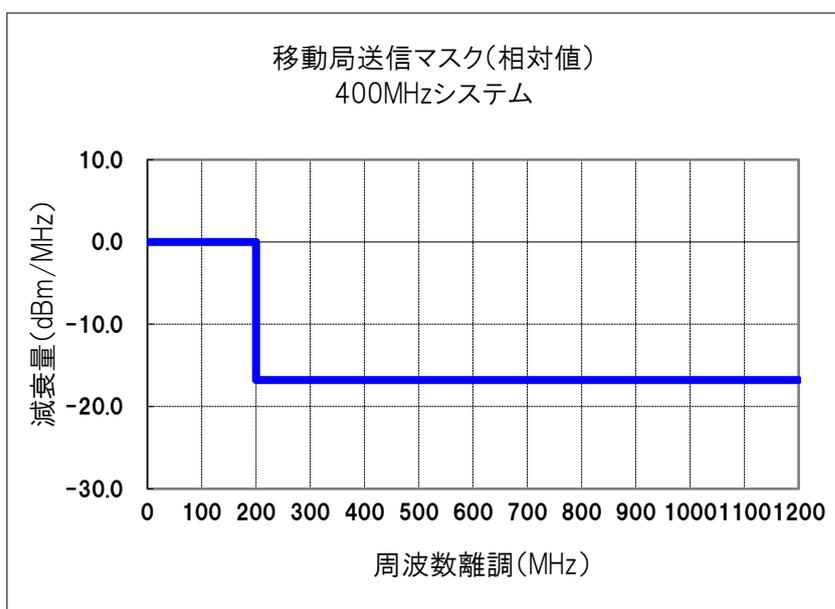
システム帯域幅の中心から離調 600MHz まで : ACLR を基に設定 (-19.80dBm/MHz)
