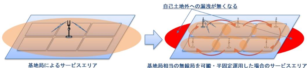
図 2. 3. 2. 2-2 固定運用と移設運用のエリア設計
