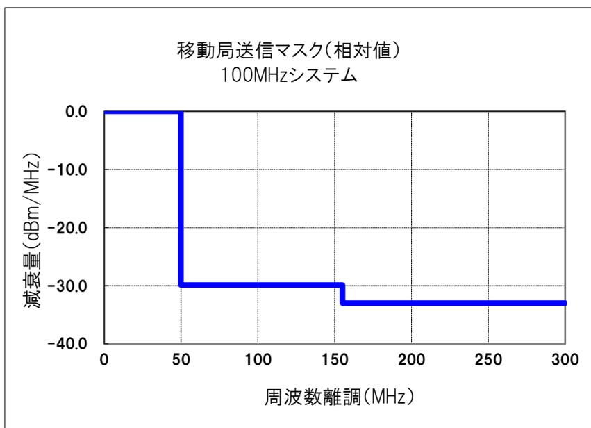
システム帯域幅の中心から離調 155MHz まで : ACLR を基に設定 ( - 26.9dBm/MHz)
