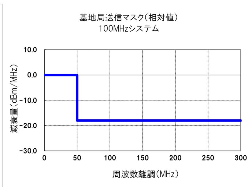
システム帯域幅の中心から離調 150MHz まで : ACLR を基に設定 (-13dBm/MHz)
