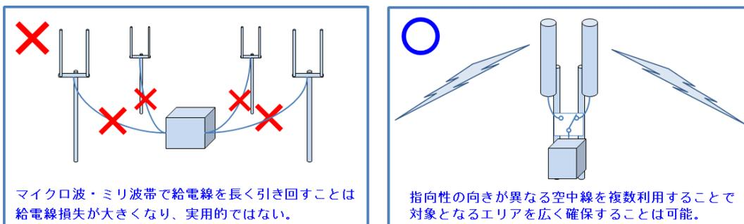
マイクロ波・ミリ波帯で給電線を長く引き回すことは給電線損失が大きくなり、実用的ではない。
