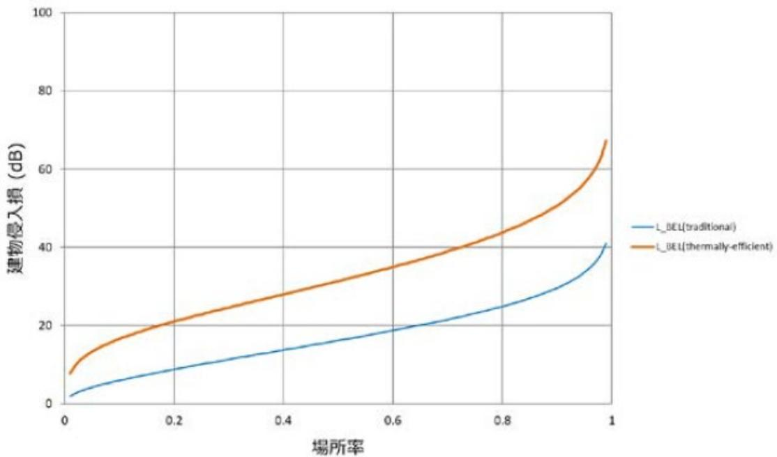
図 4. 2. 1. 2-5 4.7GHz 帯の建物侵入損
