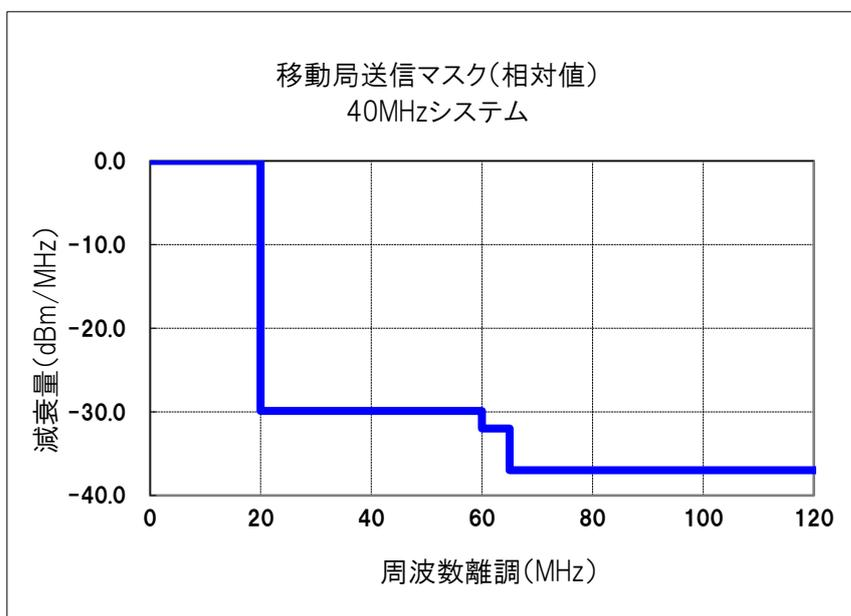
システム帯域幅の中心から離調 60MHz まで：ACLR を基に設定（ - 22.9dBm/MHz）
