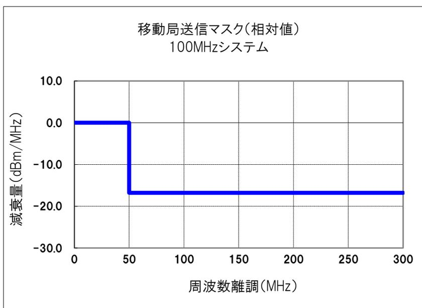
システム帯域幅の中心から離調 150MHz まで : ACLR を基に設定 (- 13.78dBm/MHz)
