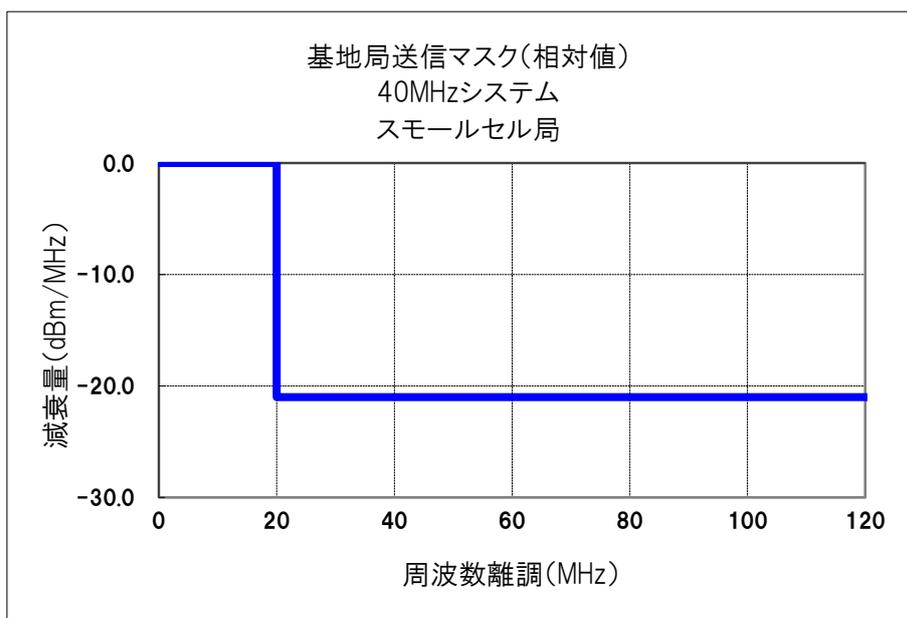
システム帯域幅の中心から離調 100MHz まで : ACLR を基に設定 ( - 16dBm/MHz)
