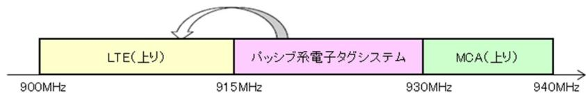
図参 4.3.3 パッシブ系電子タグシステムから携帯電話システム (LTE) 上りへの影響
