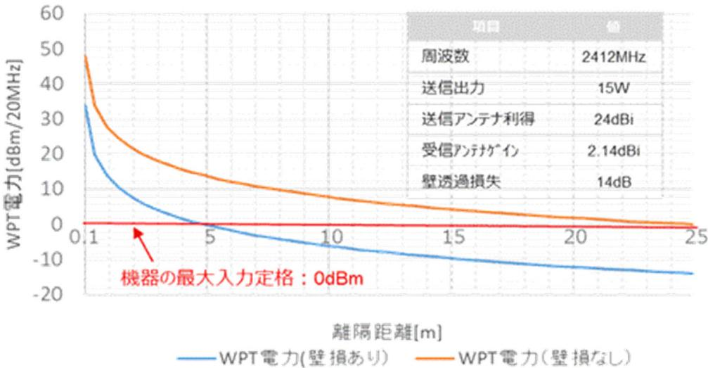
図参 5.1.6 離隔距離による到達電力
