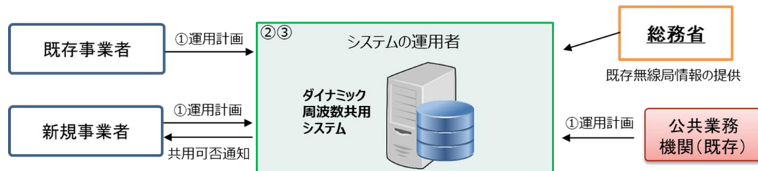
図3. ダイナミック周波数共用システムを用いた新たな運用調整の仕組み
