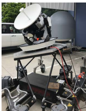
図 2 6 軸モーションプラットフォームによる捕捉追尾性能確認
