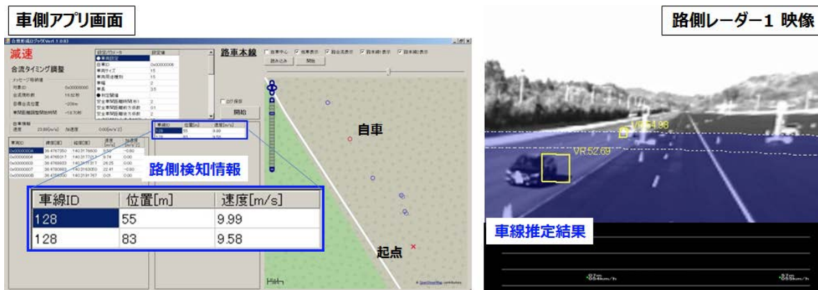
図10 車側における路側検知情報の活用例/路側レーダーの検知データ例
