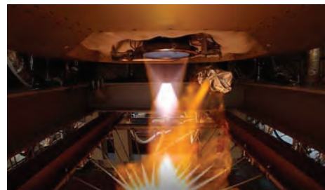
40%推力レベルの燃焼状況
