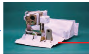
小型光通信装置「SOLISS」 特徴：約千キロ先のアンテナを約100mの精度で狙う
