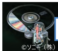
光ディスク技術 特徴：数ミリ先のディスクを約100nmの精度で狙う
