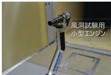
図1 小型エンジンを用いた低騒音風洞試験
