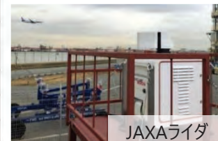
羽田空港でのライダによる後方乱気流の観測 (13ヶ月間で13,265機を観測)
