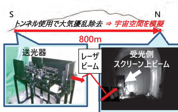
トンネル内でのレーザ無線電力伝送実験
