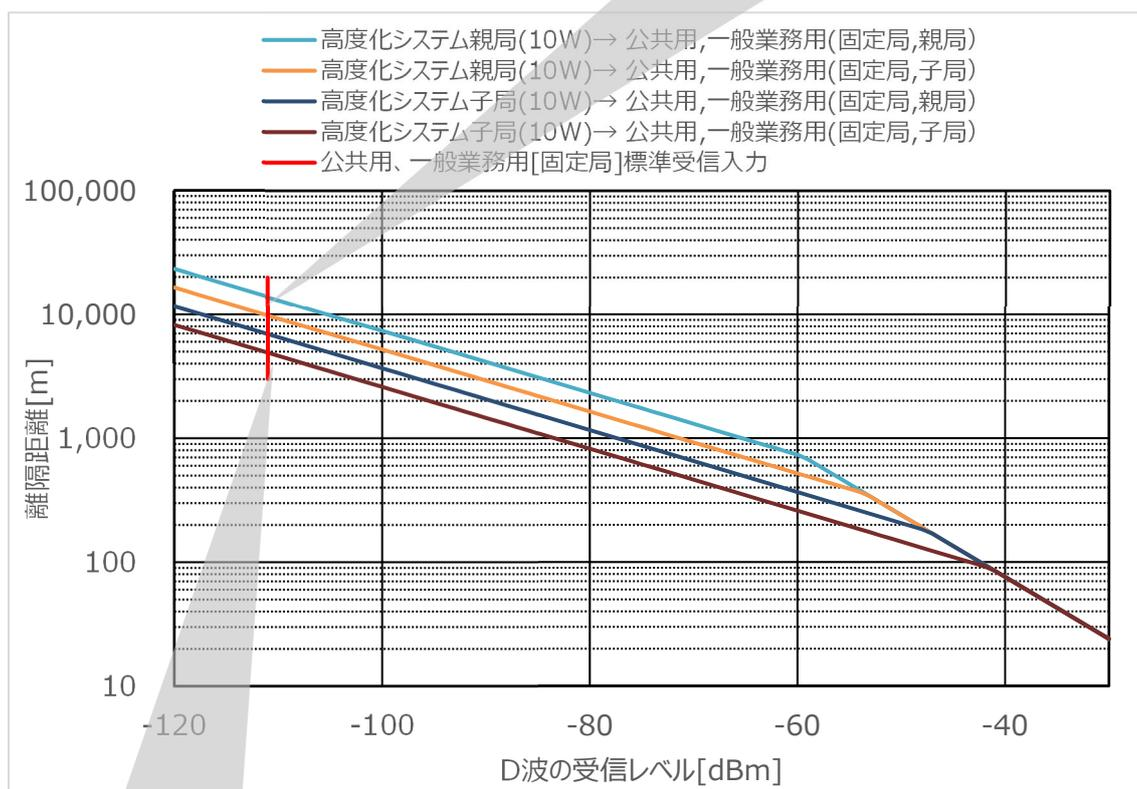
高度化システム(親局)から公共用,一般業務用(固定局,子局)[緑実線]に対して必要な離隔距離=9.8km
