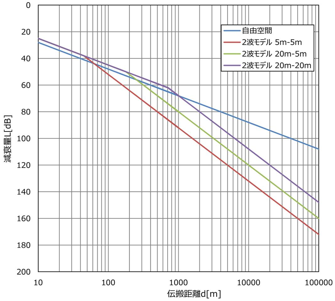
図 2-13 大地反射の2波モデルの特性曲線
