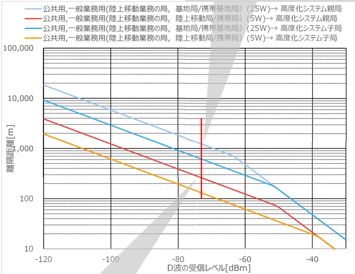
公共用(陸上移動業務の局,陸上移動局/携帯局)から高度化システム親局[赤色実線]に対して必要な離隔距離=260m (離調周波数 1MHz)
