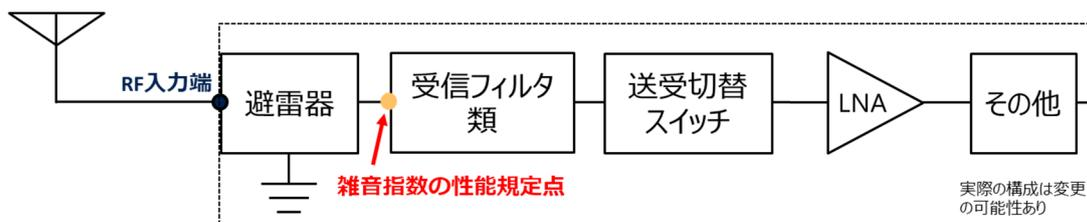
図 3-4 雑音指数の性能規定点の例
