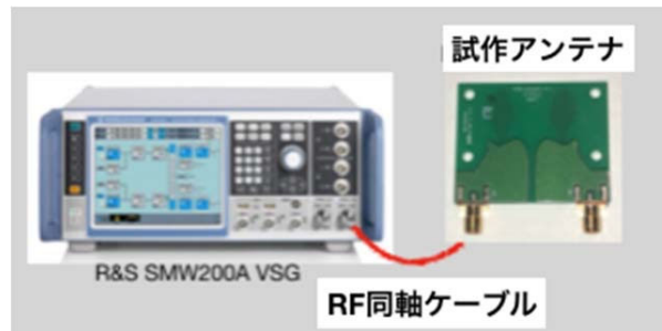
図 3-1 屋外実験で用いた UWB 無線システム（与干渉装置）のシステム構成
