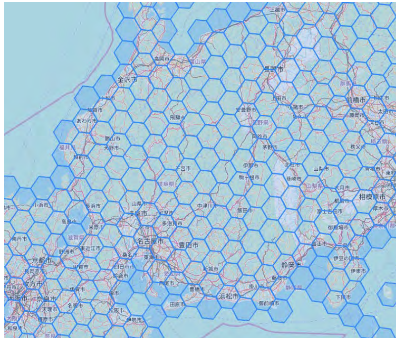
図 1-3 Ku 帯非静止衛星通信システム (500km) のビームカバレッジイメージ
