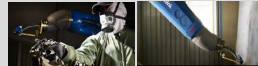
遠隔地のロボットアームが塗装を行うシステムを開発。
