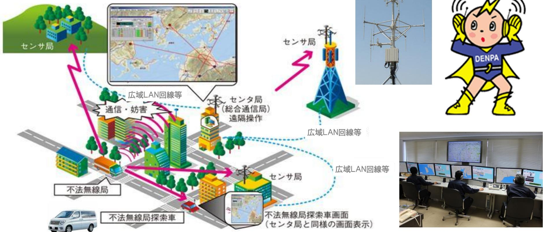
各地に設置されたセンサ局や車両に搭載されたセンサ局を、総合通信局等に設置されたセンタ局や不法無線局探索車から遠隔操作することにより、センサ局で受信した電波をモニタしたり、その電波発射源の方位等を測定して、不法無線局の位置等を特定します。
