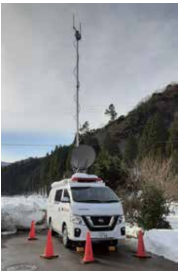
衛星回線を使った 移動基地局車によ るエリア救済 (兵庫県)
