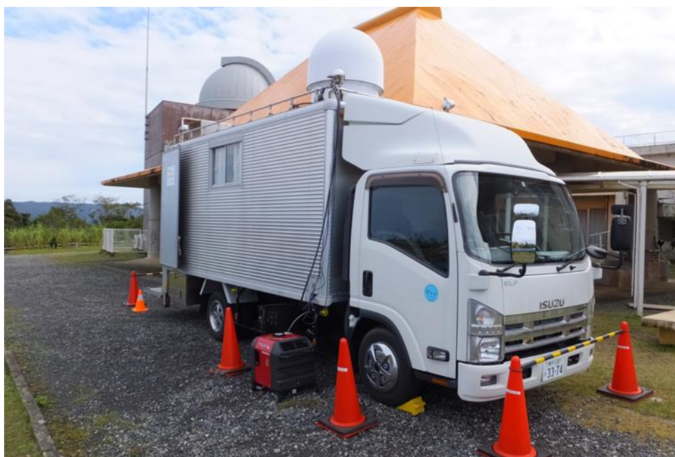
図1 二重偏波気象レーダー設置状況
